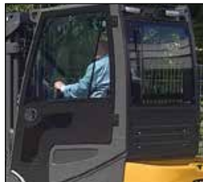
Cabina del operador elevada (para aplicaciones especiales)
