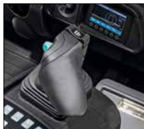
Control unificado por palanca de mando
